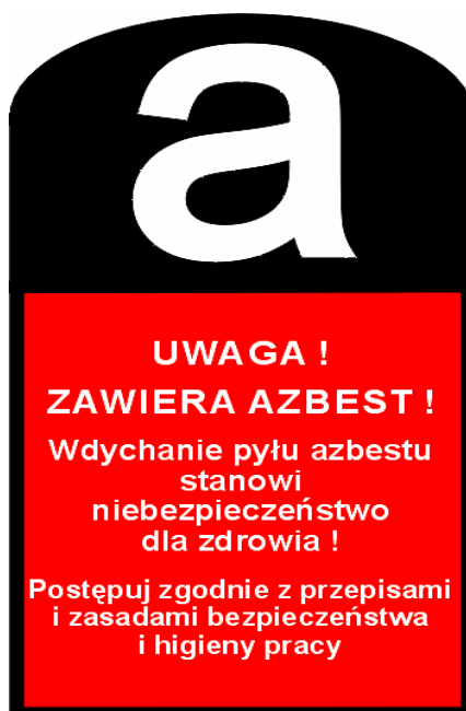
Rys. 15. Wzór oznakowania – pomieszczenie zawiera azbest
